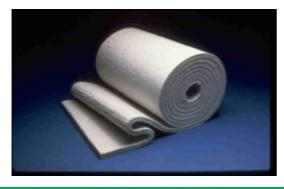
A Manta Insulfrax é classificada pelo Underwriters Laboratories (UL), conforme o UL 723 (ASTM E-84). Índice de Propagação de Chama = 0, Índice de Desenvolvimento de Fumaça = 0. A alta resistência à tensão e as excelentes propriedades térmicas se combinam para fazer da Manta Insulfrax o produto de escolha para uma ampla variedade de aplicações num grande número de indústrias:
